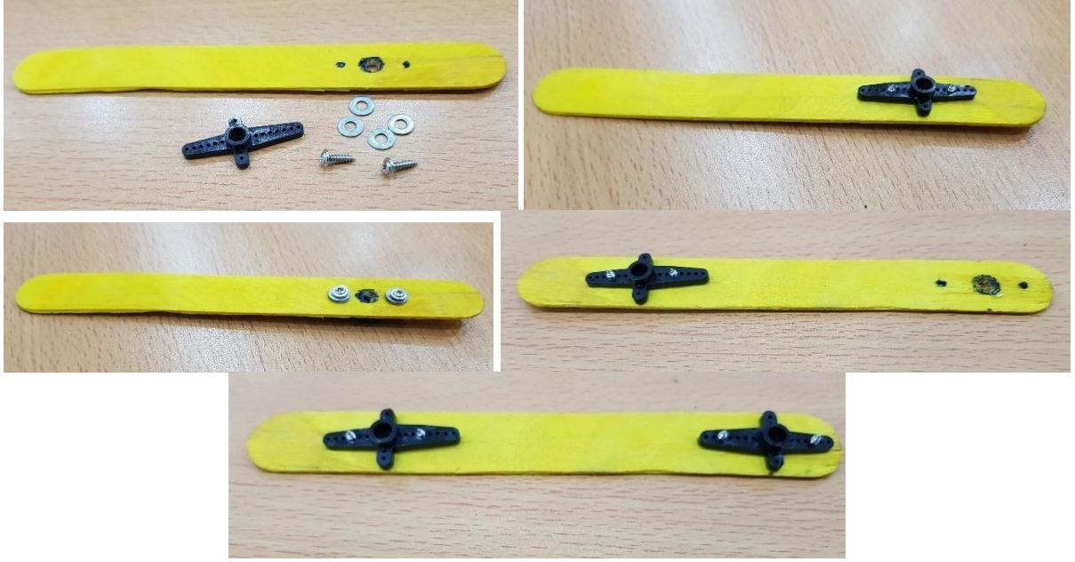
Resim 5.7. Abeslanglara servo motor T-plastik parçalarının takılması
