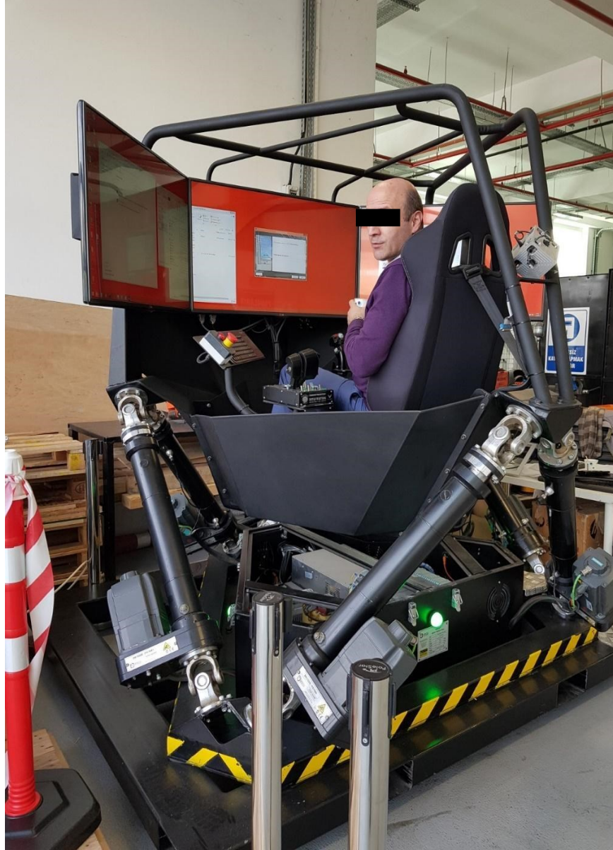
Resim 1.6 Bir paralel robot mekanizması (Ghorbani, 2018)
