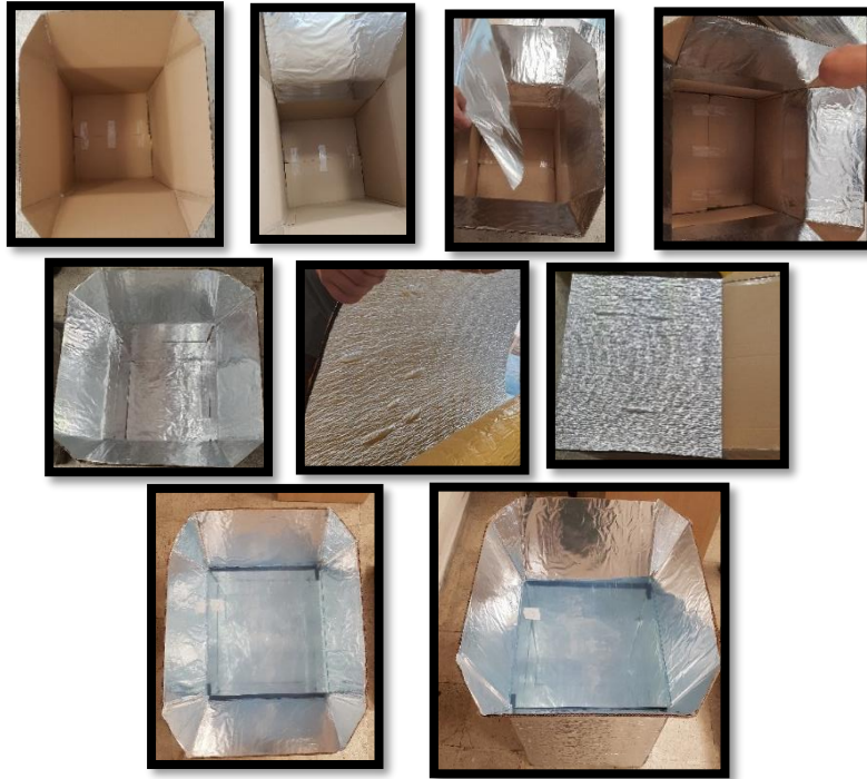
Şekil 6-7 Kurutma fırını ile güneş enerjisinden ısı enerjisi elde etme deney hazırlanışı ve düzeneği
