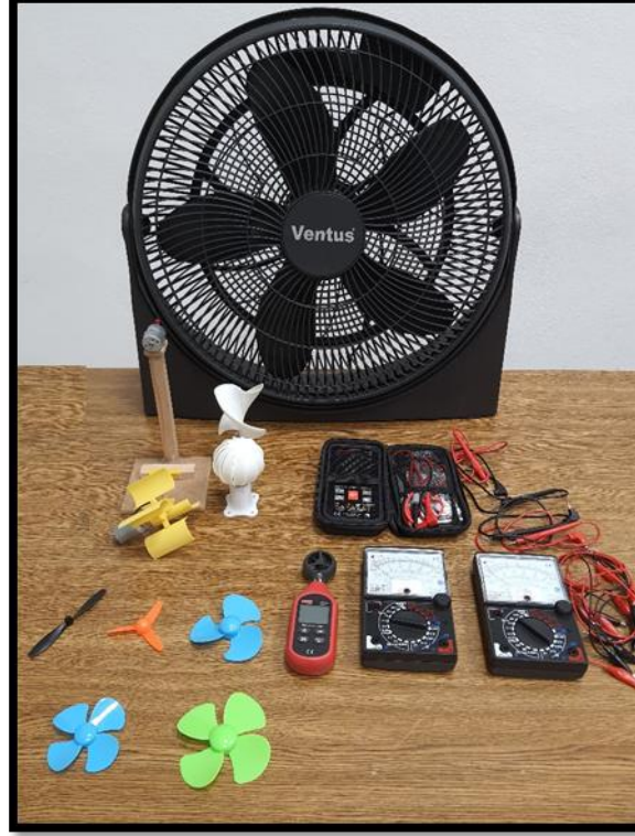
Şekil 9-5 Rüzgâr türbinlerinde farklı kanat tiplerinin enerji üretimine etkisi deney elemanları
