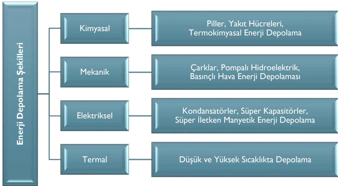
Şekil 11-1 Enerji depolama şekilleri
