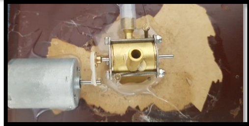
Şekil 4-5 Isı enerjisinden elektrik enerjisi elde etme deney düzeneği
