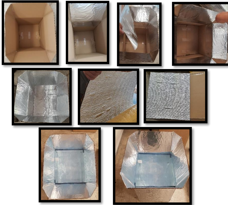
Şekil 6-6 Kurutma fırını ile güneş enerjisinden ısı enerjisi elde etme deney hazırlanışı ve düzeneği
